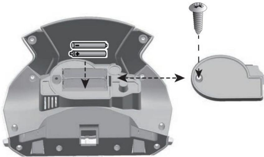
19. À l'aide d'un petit tournevis, retirez la vis du couvercle de la batterie (2).
