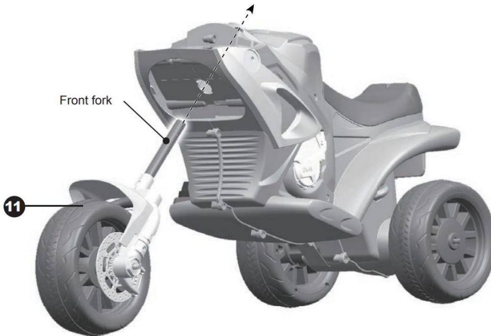
12. Retirez la vis M5x35 (4) et écrou Ø5 (5) à partir du bout de la fourche avant (11).
