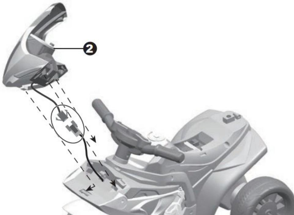
17. Branchez le connecteur du fil de lumière sur la protection faciale (2) dans le connecteur sur le véhicule.
