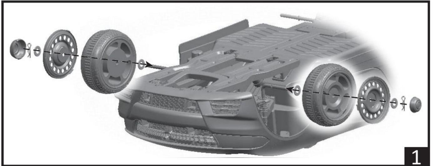
2. Dans l'ordre insérer sur l'axe arrière : moteur d'entraînement, roue arrière, enjoliveur, rondelle  $\Phi 10$  puis la goupille, et enfin le cache écrou. Faire de même de l'autre côté.
