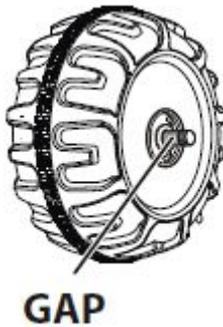
**AVERTISSEMENT** : Après avoir assemblé une roue sur les essieux, veuillez vérifier l'espace entre le filetage de la vis et le "GAP" (se reporter à photo ci-dessus), si l'écart est trop grand, ajoutez deux ou trois rondelles à l'intérieur de la roue. Après avoir serré l'écrou à l'extérieur de la roue, tournez la roue avec votre doigt pour vérifier si la roue peut fonctionner sans à-coups.
