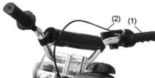
1. Vérifiez que l'accélérateur, est placé correctement et que les boulons de fixation sont serrés.
