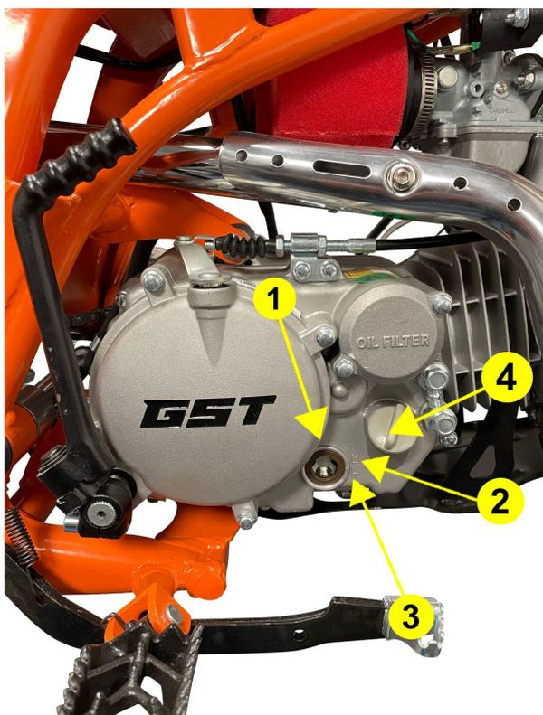
Le niveau d'huile moteur doit être vérifié avant chaque utilisation. Vous devez le vérifier grâce à la fenêtre placée sur le carter droit de la moto, comme sur l'image (1). Voici les étapes à suivre :
