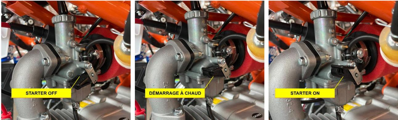
Cette option est à utiliser lorsque vous démarrez votre véhicule à froid. Une fois votre moteur démarré, vous pouvez l'enlever. Utilisé pour réduire la quantité d'air entrant dans le carburateur à basse température, il augmente la pression d'huile au niveau du port d'injection de carburant et augmente la concentration du mélange pour démarrer.
