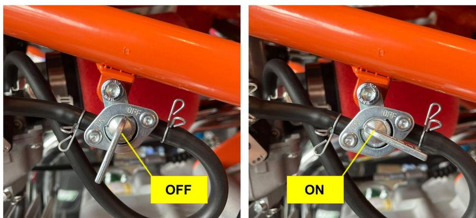
Le carburant est filtré et envoyé vers le carburateur. Le sens du robinet est indiqué grâce à la flèche :
