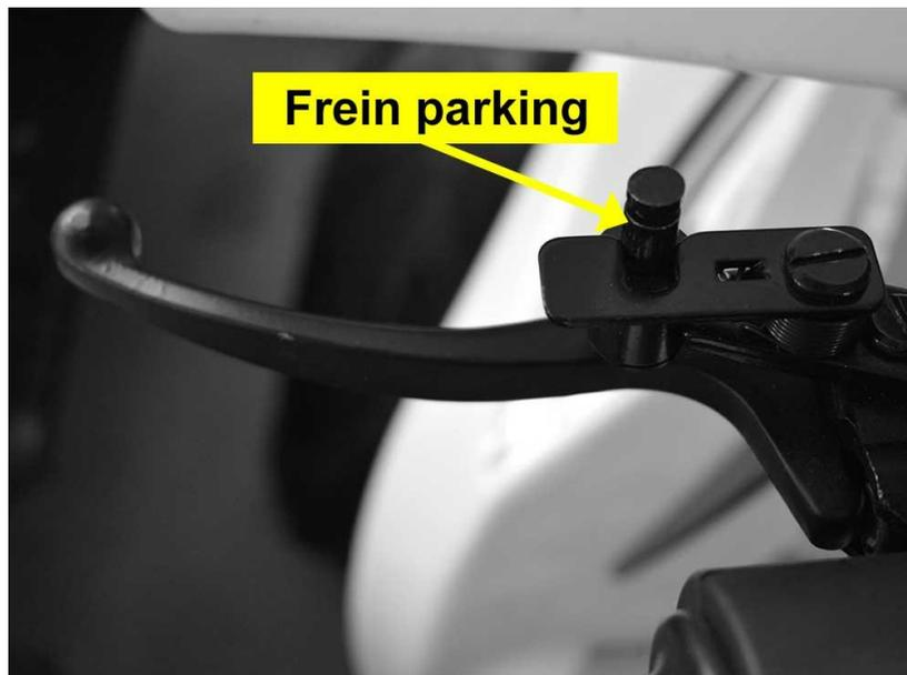
Le frein de parking doit être utilisé dans deux cas : avant le démarrage du moteur et pour le stationnement.
