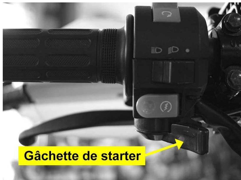
Placer sur le guidon à gauche, le poussoir du starter vous permet de réguler votre arrivée d'air. Le tirer vers la gauche pour le démarrage à froid, le repousser vers la droite après quelques secondes de fonctionnement une fois le moteur chaud.
