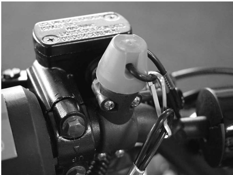
Ce cordon coupe-circuit situé sur la partie gauche du guidon à deux positions : "ON" et "OFF".
