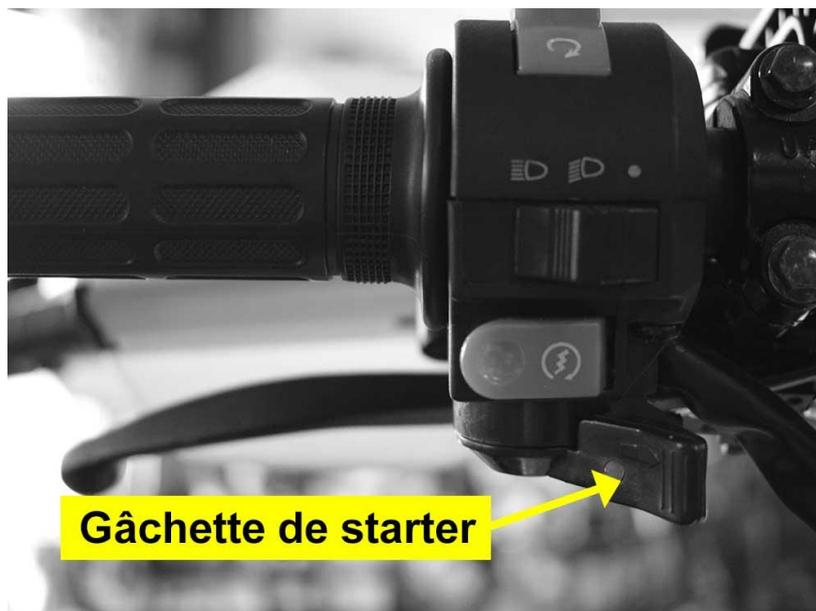
Placer sur le guidon à gauche, le poussoir du starter vous permet de réguler votre arrivée d'air. Vous devez le tirer vers la gauche pour le démarrage à froid, le repousser vers la droite après quelques secondes de fonctionnement une fois le moteur chaud.
