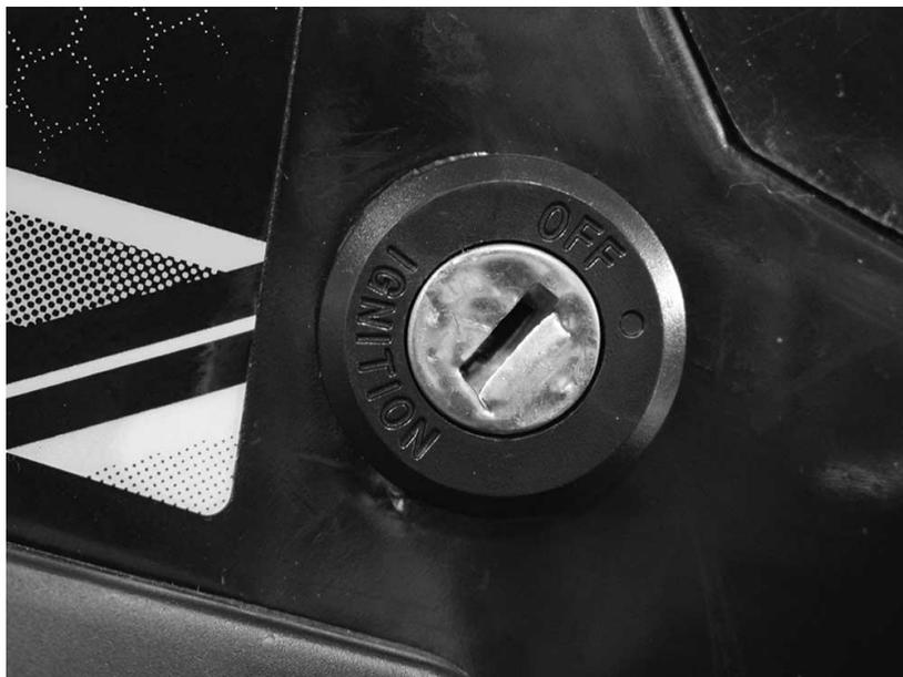
Le contacteur à clé est placé sur le côté avant droit du véhicule et comporte 2 positions "ON" et "OFF"
