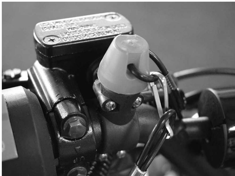
Ce cordon coupe-circuit situé sur la parti gauche du guidon à deux positions : “ON” et “OFF”.
