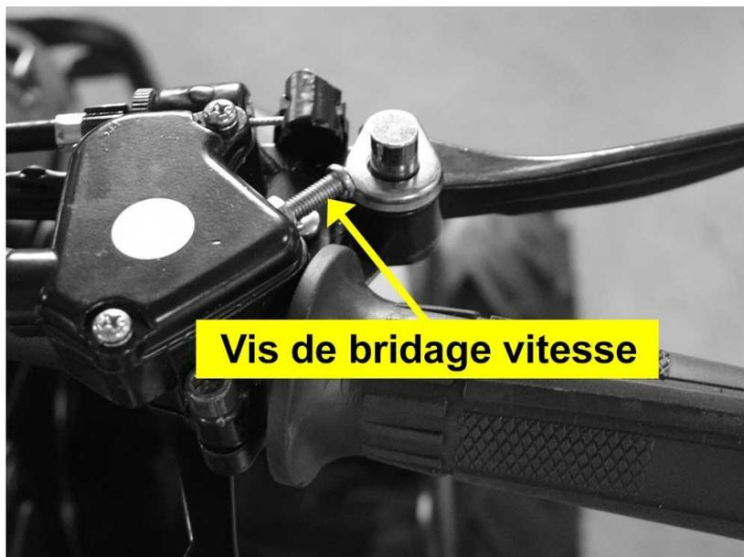
A l'arrière de la fixation de la gâchette d'accélérateur, vous trouverez une vis qui vous permettra de bloquer la vitesse maximum du véhicule.
