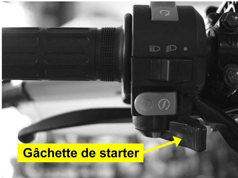
Placer sur le guidon à gauche, le poussoir du starter vous permet de régler votre arriv e d'air. Le tirer vers la gauche pour le d emarrage   froid, le repousser vers la droite apr es quelques secondes de fonctionnement une fois le moteur chaud.
