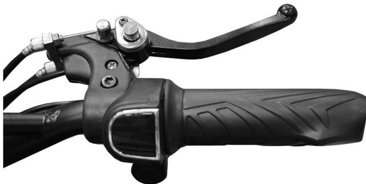
L'indicateur de charge renseigne sur le degré de charge de la batterie.
