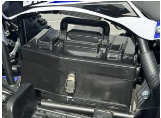
4 / de sortir la batterie du cadre du véhicule
