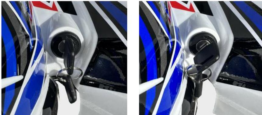
Le contacteur à clé est placé sur le côté droit du véhicule. La clé est indispensable pour l'utilisation du quad.
