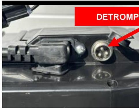
Le connecteur de charge est placé sur le compartiment de batterie supérieur (côté droit du véhicule). Avant toute charge, vérifiez qu'aucun corps étranger ne s'est inséré dans le connecteur de charge. Il doit être sec et parfaitement propre avant de brancher le chargeur fourni par la marque. Après chaque charge ou utilisation, vérifiez que le capuchon d'étanchéité soit remis dans sa position initiale.
