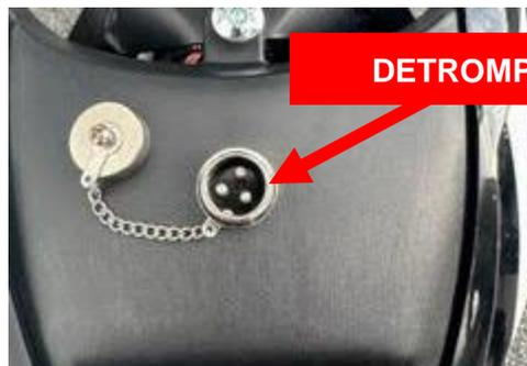
Le connecteur de charge est placé sur le dessus de la moto, sur le cache imitant un réservoir à essence. Avant toute charge, vérifiez qu'aucun corps étranger ne s'est inséré dans le connecteur de charge. Il doit être sec et parfaitement propre avant de brancher le chargeur fourni par la marque. Après chaque charge ou utilisation, vérifiez que le capuchon d'étanchéité soit remis dans sa position initiale.
