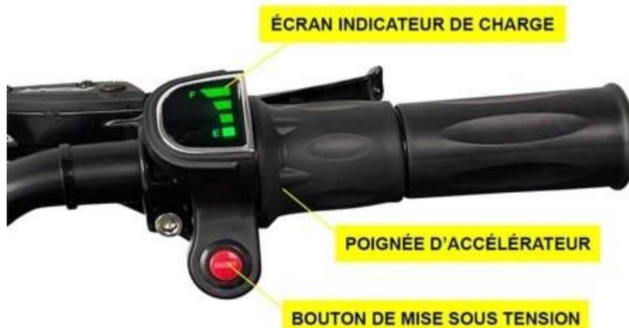
L'écran indicateur de charge retranscrit visuellement la charge de la batterie du véhicule à l'utilisateur. Il ne s'agit pas d'un compteur de vitesse.
