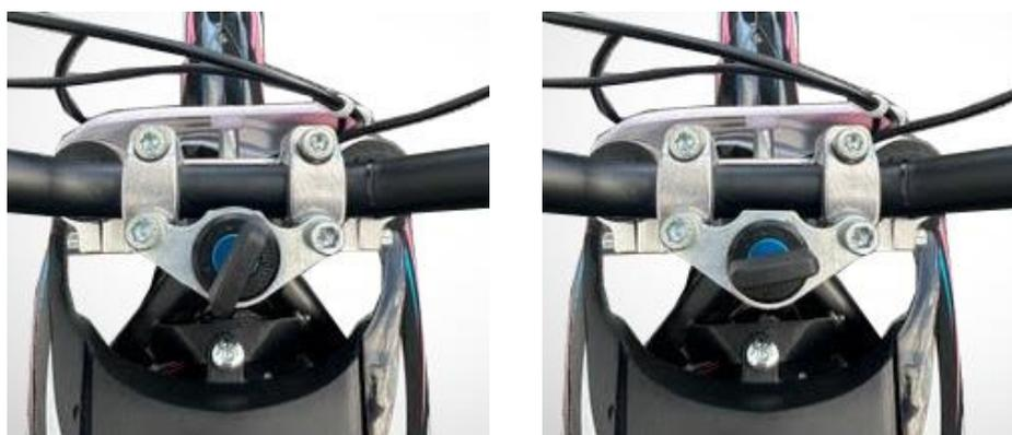
Le contacteur à clé est placé au milieu du guidon. La clé est indispensable pour l'utilisation de la moto. Le contacteur à clé présente 2 positions :
