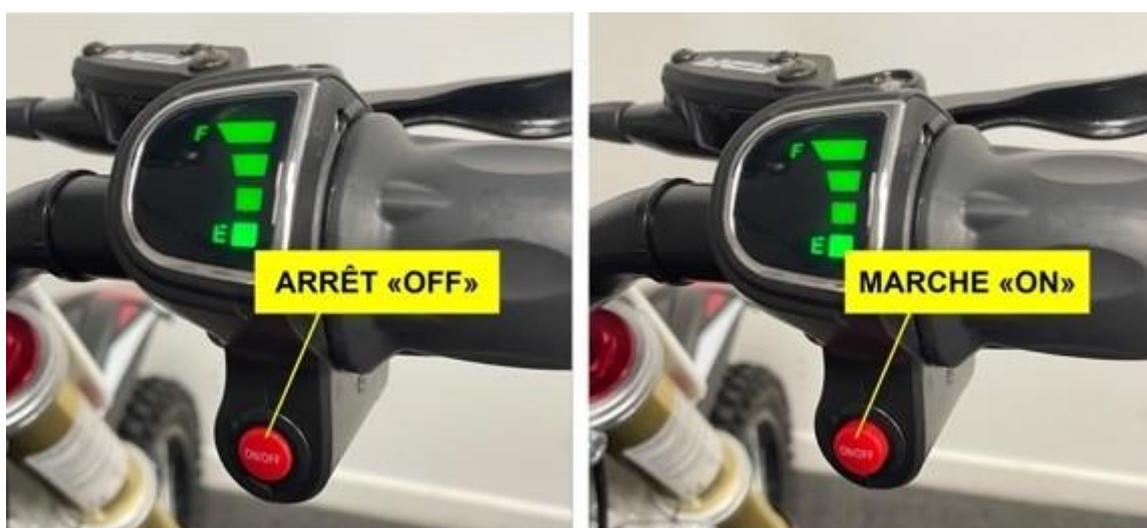
La position du bouton de mise sous tension est la dernière étape pour le démarrage du véhicule. **2 positions** :
