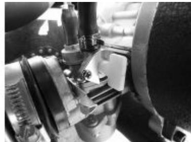
ON : rotation de la valve de carburant sur ON avant d'essayer de mettre en marche le moteur permet au carburant de s'écouler du réservoir de carburant jusqu'au carburateur
